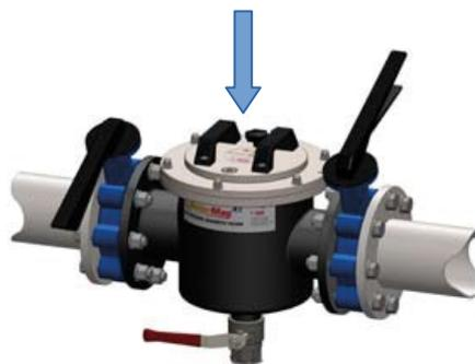
8. Riaprire entrambe le valvole di isolamento. Se necessario aprire lo sfiato visualizzato nella parte superiore dell'unità per rilasciare l'aria intrappolata.
